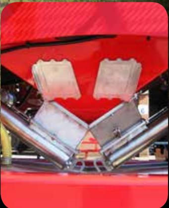
Mešač se može uključiti i za lakša i teža semena kako bi se obezbedio jednak protok ka ORGA sistemu. Takođe, sejalica ima razmenjivač toplote koji pruža svu vazduh sistem u suvim a time smanjuje , a time sprečava nagomilavanje semena čak i u vlažnim uslovima setve.
