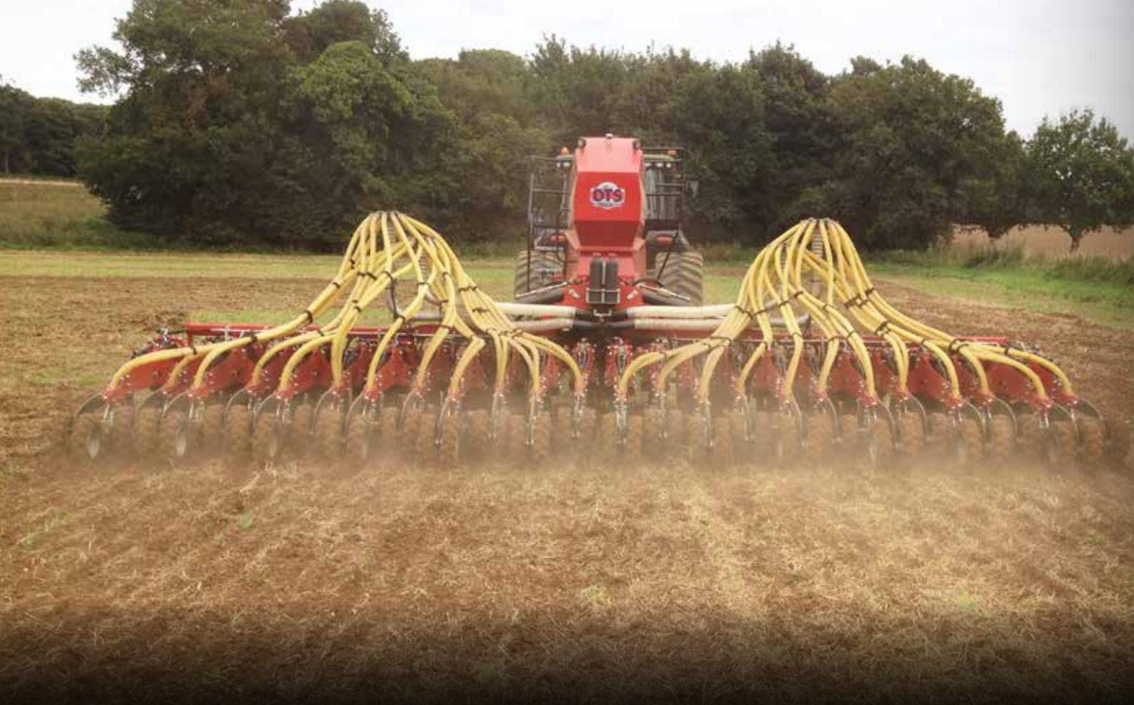
DTS je dizajnirana da radi direktno u ostacima prethodnog useva, a takođe će dobro raditi u sistemima gde se vrši redukovana obrada ili konvencionalna sa plugom.
